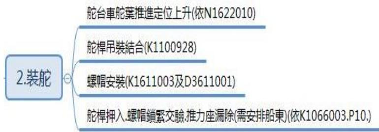
圖 4-1. 舵葉安裝施工項目樹狀圖
